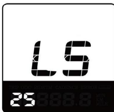
Interface des paramètres de limite de vitesse
