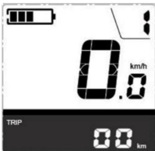
Interface des paramètres de dégagement de la distance parcourue
