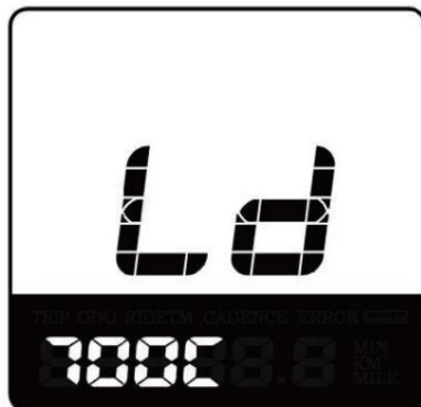
Interface de paramètres de diamètre de roue
